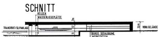
Schnitt durch den geplanten Bunker
